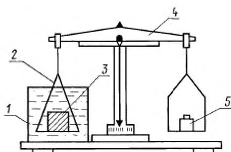
1 — сосуд с водой; 2 — подвес для образца; 3 — образец;
